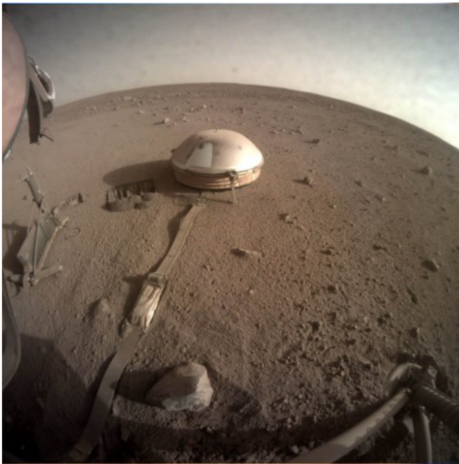
Photo de SEIS posé sur Mars, prise par la caméra de contexte de l'instrument (ICC) © NASA/JPL-Caltech
