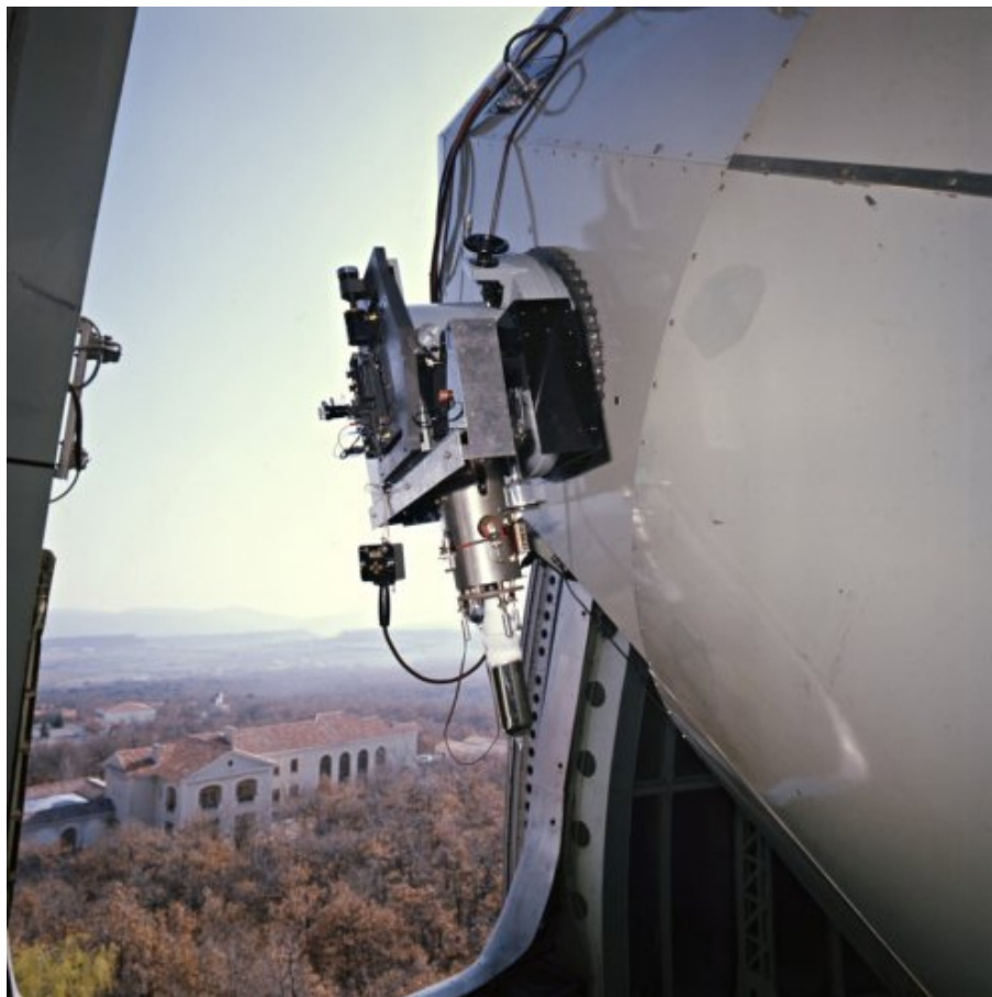
Caméra électronique Lallemand-Duchesne au foyer Newton du télescope de 193 cm de l'O.H.P. Photothèque OHP/CNRS
