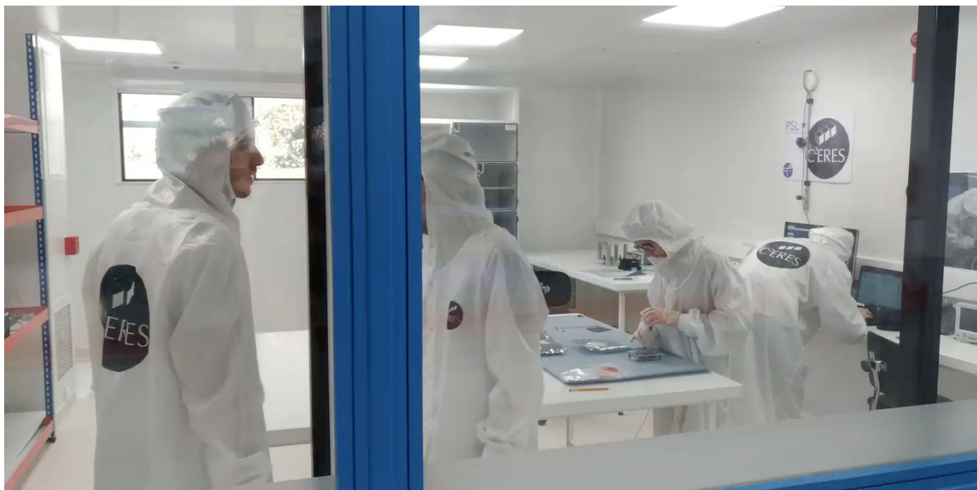
Tests en salle propre de composants dits « sur étagère » pour nanosatellites (satellites jusqu'à environ 10-50kg).[ en] © Boris Segret/Observatoire de Paris, Author provided
