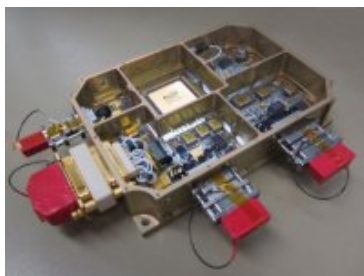
Boîtier électronique de VIHI ( Jérôme Parisot/LESIA/Observatoire de Paris )
