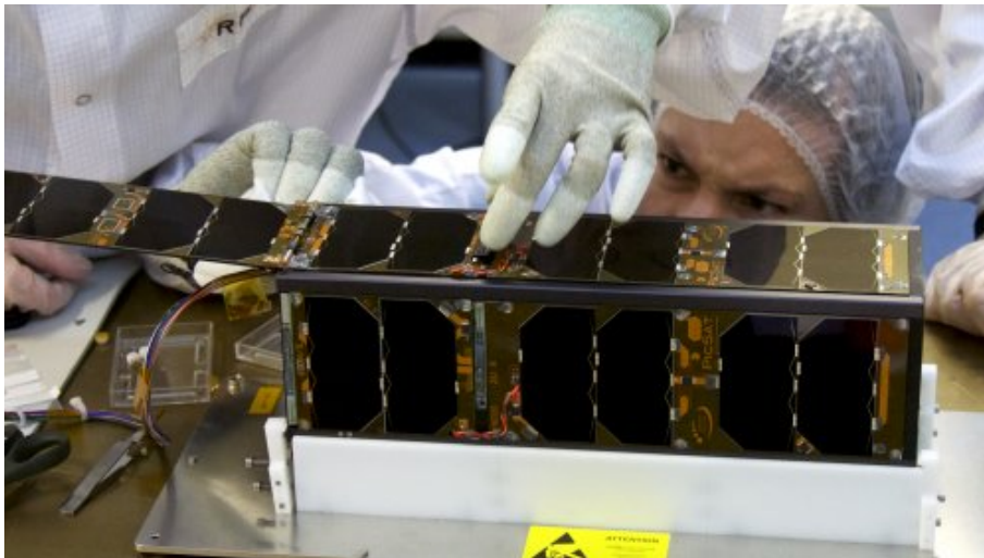
Intégration du nanosatellite PicSat à l'Observatoire de Paris - PSL copyright LESIA/Observatoire de Paris/PSL/Maarten Roos
