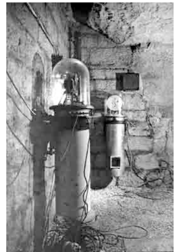
Pendule de précision à pression constante dans la cave de l'Observatoire de Paris © Bibliothèque de l'Observatoire de Paris
